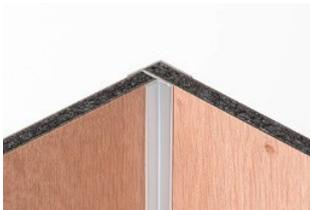
Das zweite RESOPAL SpaStyling BOARD wird vor der Wand auf 3 mm Distanzhalter aufgesetzt, in das Eckprofil eingeschoben und anschließend in das Klebebett gedrückt. Die Verbindung zwischen Profil und RESOPAL SpaStyling BOARD muss wasserdicht ausgeführt werden. RESOPAL SpaStyling Verbindungsklebstoff, der aus den Profilen ausgequollen ist, muss sofort von der Oberfläche entfernt werden.
