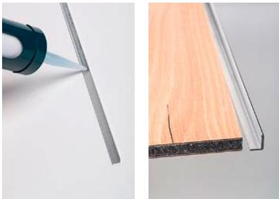
In die Profillinenseite von RESOPAL SpaStyling Abschlussprofil (L-Profil) RESOPAL SpaStyling Verbindungsklebstoff angeben. Die Angabe von dem Klebstoff muss genau dosiert werden.
