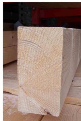
Trockenes KVH verändert in Abhängigkeit von der Gleichgewichtsfeuchte sein Reißbild und seine Geometrie nicht mehr oder nur noch in sehr geringem Umfang. Dadurch ist die Maßhaltigkeit der Bauteile im Einbauzustand gewährleistet. Nachteilige Veränderungen, wie übermäßige Reißbildung, starkes Verdrehen usw. sind ausgeschlossen.
