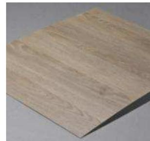
EGGER Schichtstoff XL ist ein dekorativer Schichtstoff auf Basis härthbarer Harze. Schichtstoff XL ist mehrschichtig aufgebaut, besteht aus melaminharz imprägniertem Dekorpapier und mehreren mit Phenolharz imprägnierten Kernlagen, die unter hohem Druck und Temperatur miteinander verpresst werden.
